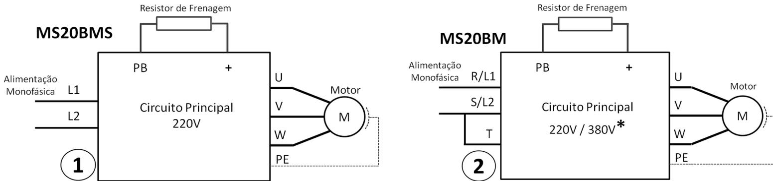
\* A tensão de alimentação para os diagramas 1 e 2 deve ser 220V, podendo ser originada por FASE+FASE (220V de Rede) ou FASE + Neutro (380V de Rede). Para ambos os circuitos, o motor deverá estar fechado em 220V.
