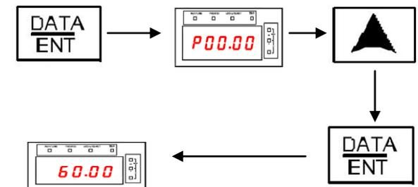
Agora, pressione **PRG/ESC** Vá ao grupo **P02**, aperte **DATA/ENT**, vá ao **P02.02** e altere para **60 Hz**, referente a frequência de base do motor. Ao final tecla **PRG/ESC** duas vezes para retornar.
