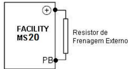
A série FACILITY possui módulo de frenagem para aplicações que requerem parada do motor em um curto período de tempo. É necessário utilizar Resistor de Freagem de acordo com a tabela abaixo para estas aplicações.
